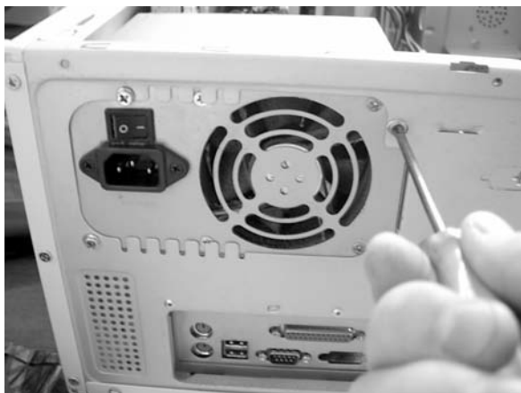
Рис. 15.13. Извлечение блока питания
