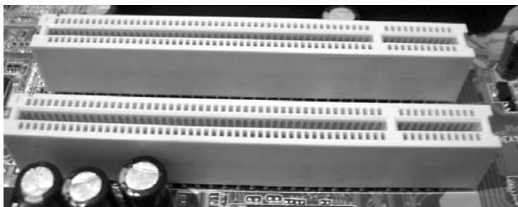
Рис. 2.14. Слоты PCI
