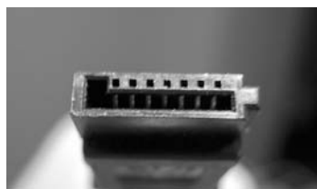
Рис. 15.24. Ключ на SATA-шлейфе (выступ и запаянное отверстие)
