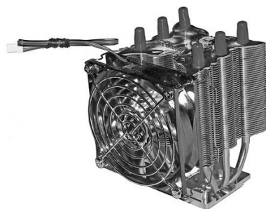
Рис. 2.24. Пример кулера на основе тепловых труб
