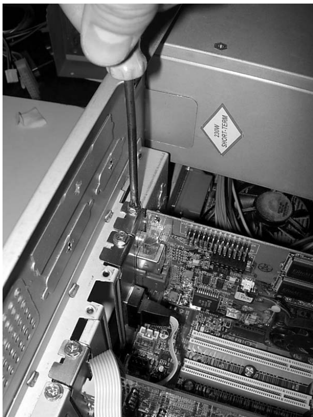
Рис. 15.21. Извлечение удерживающего видеокарту винта
