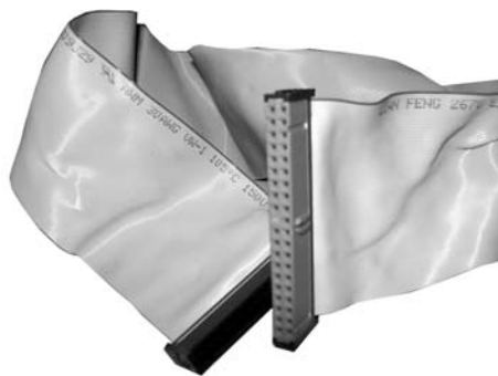
Рис. 2.35. Внешний вид IDE-шлейфа
