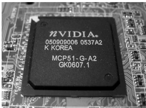
Рис. 2.10. Пример микросхемы системной логики
