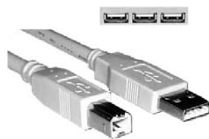
Рис. 2.18. Внешний вид USB-портов ( вверху ) и USB-коннекторов ( внизу )
