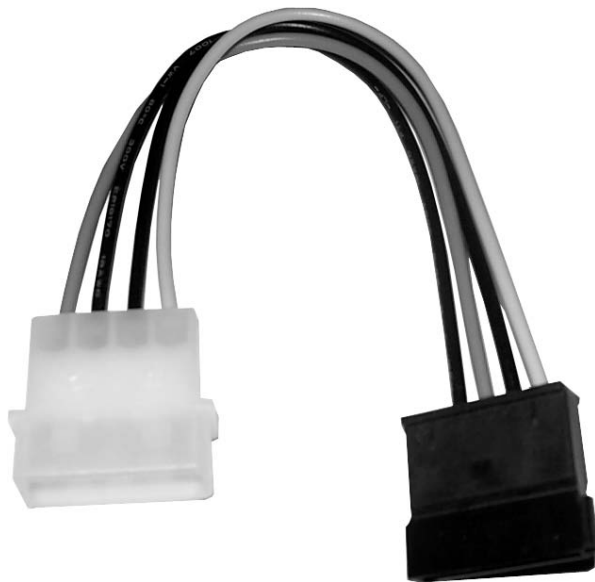
Рис. 15.25. Внешний вид переходника для питания SATA-жестких дисков
