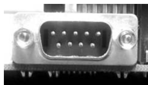
Рис. 2.17. Внешний вид 9-контактного COM-порта
