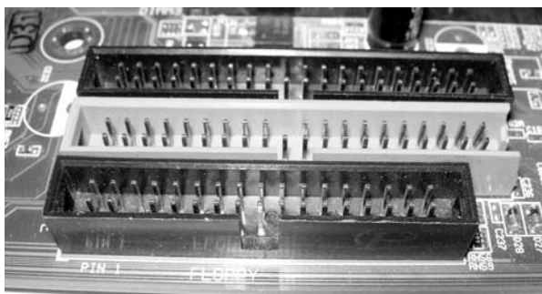
Рис. 2.15. Сверху вниз: IDE-разъемы, FDD-разъем
