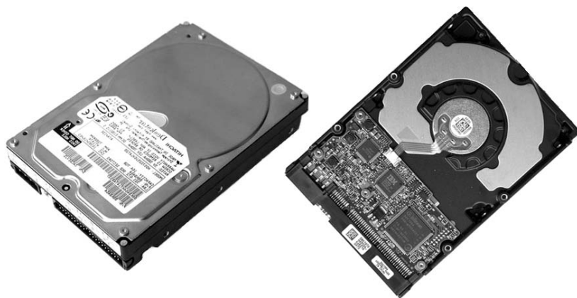
Рис. 2.34. Внешний вид винчестера (вид сверху и снизу)
