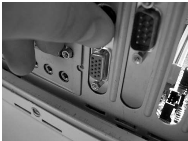
Рис. 15.22. Установка видеокарты
