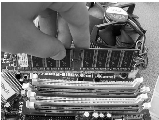
Рис. 15.19. Подготовка к установке модуля памяти
