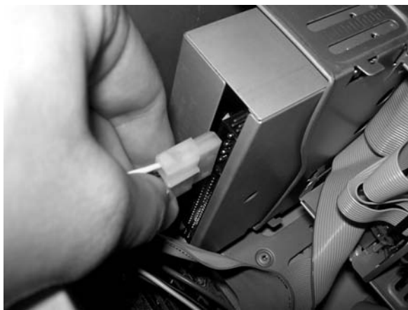
Рис. 15.14. Подключение коннекторов проводов питания к устройствам
